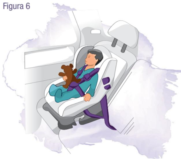
A aceleração da cabeça e a carga de tração do pescoço são reduzidas nos impactos frontais quando a criança se encontra contida neste dispositivo de segurança. Caso o veículo não possua cinto de três pontos na posição central do banco traseiro, a cadeirinha deverá ser instalada nas posições do banco de trás onde houver esse aparato (Figura 6).
